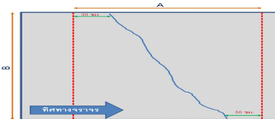
รูปที่ 2.28 ตัวอย่างการวัดความเสียหายประเภทรอยแตกทิศทางอื่นๆ (แบบที่ 2)
