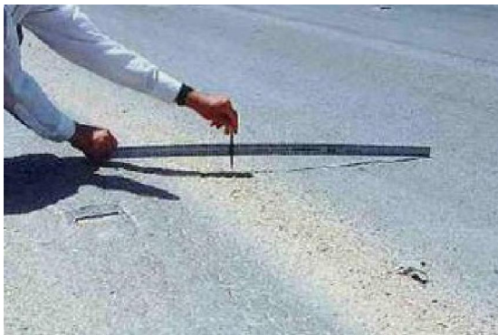
รูปที่ 2.7 ความเสียหายประเภทร่องล้อ
